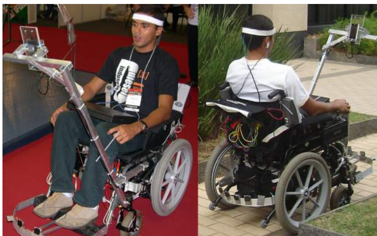
Figura 6.9. Comando da cadeira de rodas robotizada da UFES/Brasil a partir de padrões ERD/ERS.
