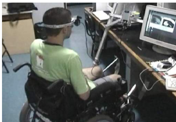
Figura 5.15. Uso da interface acionada por movimentos do globo ocular para comando da cadeira de rodas robotizada da UFES/Brasil.
