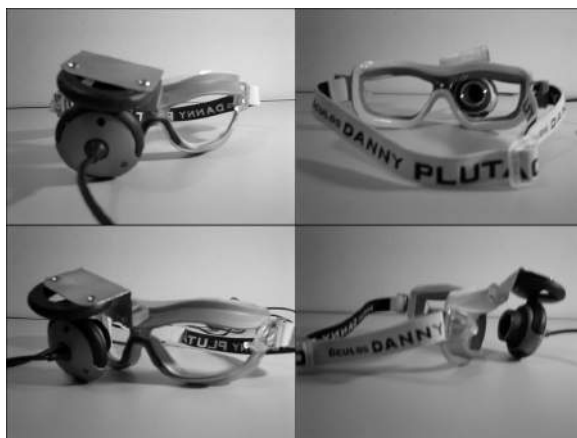
Figura 5.8. Óculos utilizados para o seguimento do globo ocular da interface da UFES/Brasil.
