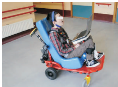
Figura 3.19. Criança com PC dirigindo o veículo PALMIBER com a interface ENLAZA (por movimentos de cabeça).
